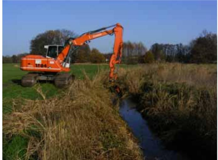
Abbildung 17: Mahd von Röhrichtbeständen mit dem Mähkorb, Vorwerker Bach bei Celle
