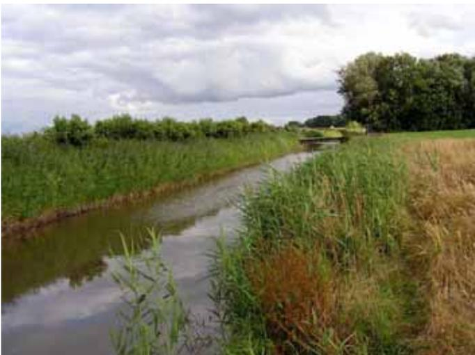
Abbildung 14: Marschgewässer, Wischhafener Schleusenfleth: Die Marschgewässer sind durch die Tide beeinflusst. Die unterschiedlichen Strömungsrichtungen und das extrem geringe Gefälle führen zu Ablagerungen im Gewässerbett, die eine ständige Unterhaltung, bis hin zur regelmäßigen Sohlräumung erforderlich machen. Eine Entwicklung als Fließgewässer nur in wenigen Einzelfällen möglich.
