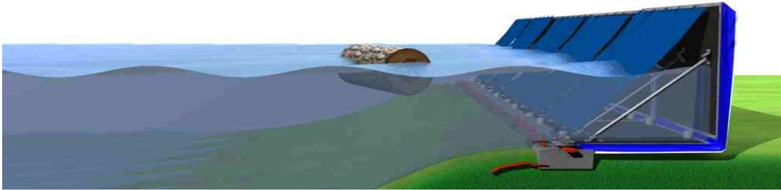
Die Elemente können durch eine reißfeste Folie, die über die Elemente gespannt wird gegen Treibgut geschützt werden. Da sich hinter der Folie Wasser befindet, wirkt diese wie ein Stoßdämpfer. (Dieses Bild hat eine Fixierung – semi mobil, gleiches gilt aber auch für die mobile Version.)
