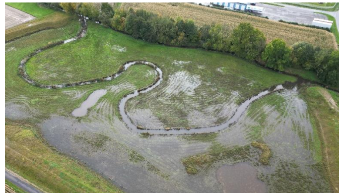
Abbildung 5: Renaturierungsmaßnahme eines stark ausgebauten Gewässers zum (Hoch-)wasserrückhalt und zur Nährstoffretention, Hunte-Oberlauf bei Bad-Essen, Landkreis Osnabrück.
